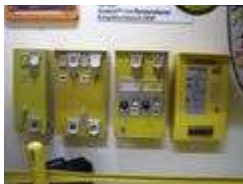
Historische Briefmarkenautomaten Von links nach rechts: Die ersten beiden mit Drehkurbel für Rollenmarken , der dritte zum Ziehen von Briefmarkenheftchen und der vierte für moderne Automatenbriefmarken
