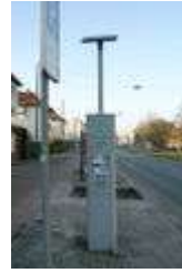
Parkscheinautomat mit Solarbetrieb
