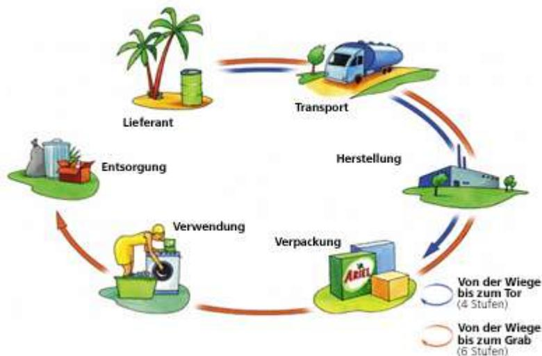
Beim Life Cycle Assessment (LCA) wird für ein typisches Produkt berechnet, welche und wie viele Rohstoffe für die Herstellung des Produkts, die Herstellung von Zwischenprodukten und schließlich für das Produkt selbst, einschließlich Verpackung und Transport der Rohstoffe, der Zwischenprodukte und des Produkts, für die Verwendung des Produkts und seine Entsorgung nach der Verwendung erforderlich sind.
